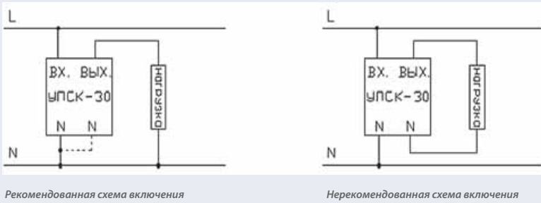
i Рис. 6. Схема подключения устройства плавного пуска
