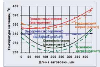
Рис. 9. Распределение температуры по длине заготовки на этапах нагрева (расчет и эксперимент)
