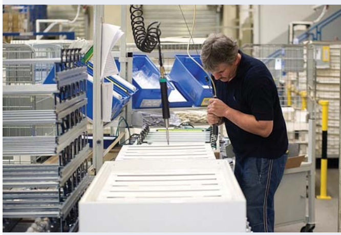
Участок сборки малых распределительных щитов
