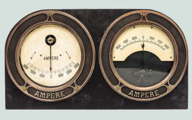
Рис. 6. Двойной амперметр начала 20-го века в деревянном корпусе.
