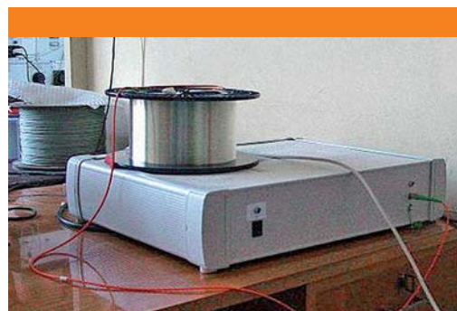
Рис. 12. Внешний вид электронного блока системы мониторинга с катушкой ОВ
