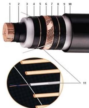
**Рис. 1** Кабель на напряжение 110 кВ с медной жилой сечением 2000мм<sup>2</sup> (Milliken), с изоляцией из СПЭ и оптоволоконными модулями производства ООО «ТАТКАБЕЛЬ»
