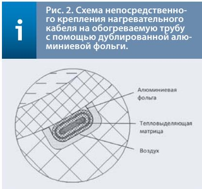
Рис. 2. Схема непосредственного крепления нагревательного кабеля на обогреваемую трубу с помощью дублированной алюминиевой фольги.
