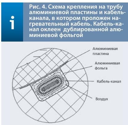
Рис. 4. Схема крепления на трубу алюминиевой пластины и кабель-канала, в котором проложен нагревательный кабель. Кабель-канал оклеен дублированной алюминиевой фольгой
