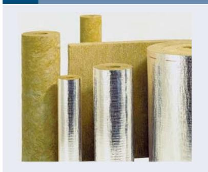
Немаловажно и то, что цилиндры производятся по навивной, а не вырезной технологии. За счёт этого теплопроводность изделия в любой точке одинакова, а механическая прочность выше, то есть при необходимости инспекции участка трубы цилиндр допускается демонтировать и смонтировать заново без его замены.
