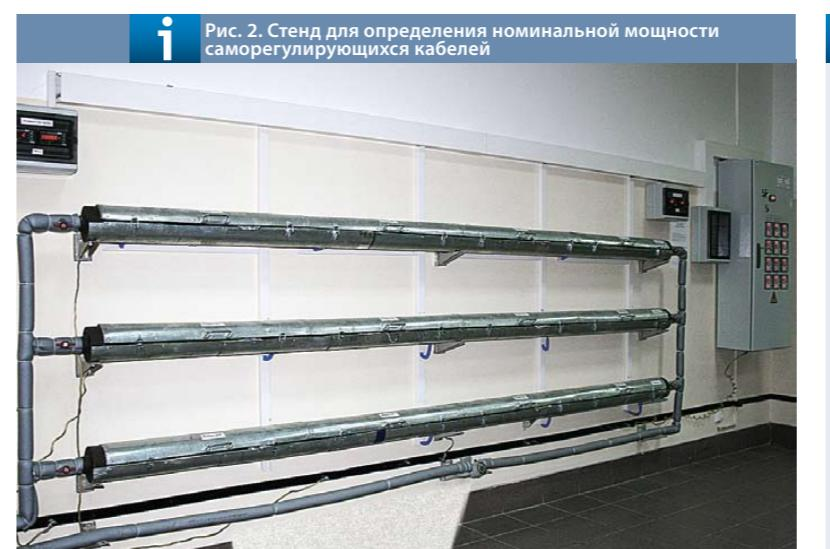
**Рис. 2. Стенд для определения номинальной мощности саморегулирующихся кабелей**
