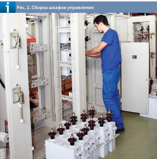
**Рис. 2. Сборка шкафов управления**
