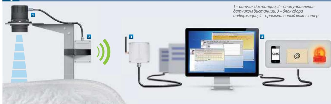
1 – датчик дистанции, 2 – блок управления датчиком дистанции, 3 – блок сбора информации, 4 – промышленный компьютер.
