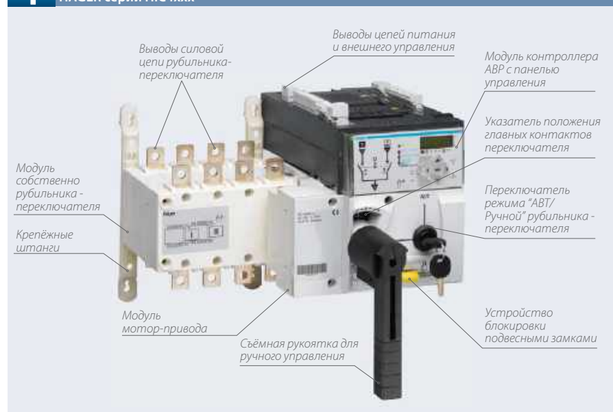
Рис. 1 Автоматический рубильник-переключатель HAGER серии НИС4xxx
