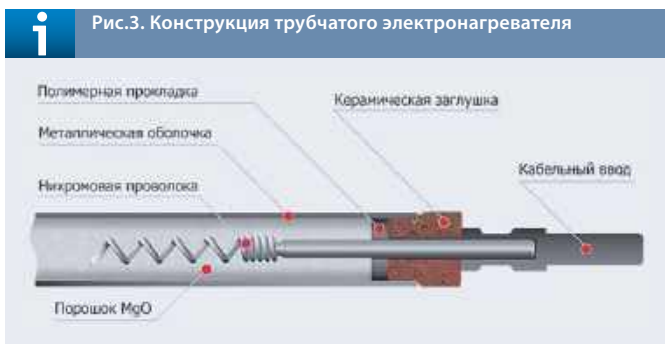
Рис.3. Конструкция трубчатого электронагревателя
