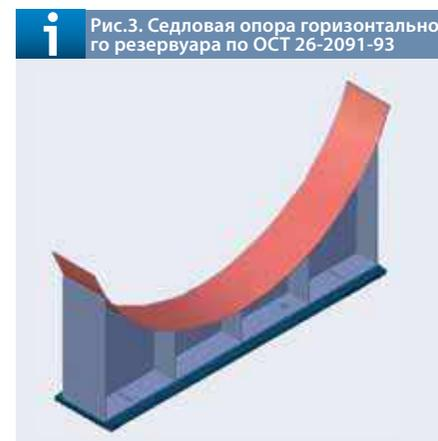
Рис.3. Седловая опора горизонтального резервуара по ОСТ 26-2091-93
