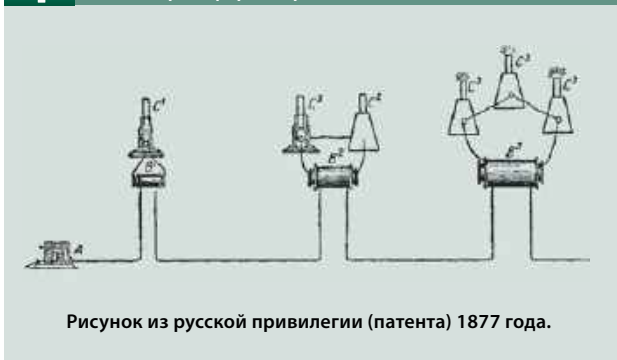
Рис. 2. Схема распределения переменного тока с трансформаторами Яблочкова.
