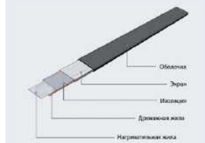
Рис.6. Конструкция нагревательного плоского кабеля марки НТ
