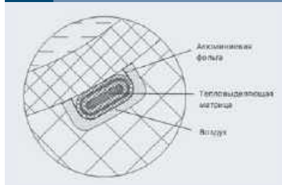
Рис. 3. Схема крепления на трубу кабель-канала, в котором проложен нагревательный кабель. Кабель-канал оклеен дублированной алюминиевой фольгой.
