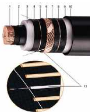
Рис.1 Кабель на напряжение 110 кВ с медной жилой сечением 2000мм² (Milliken), с изоляцией из СПЭ и оптоволоконными модулями производства ООО «ТАТКАБЕЛЬ»
