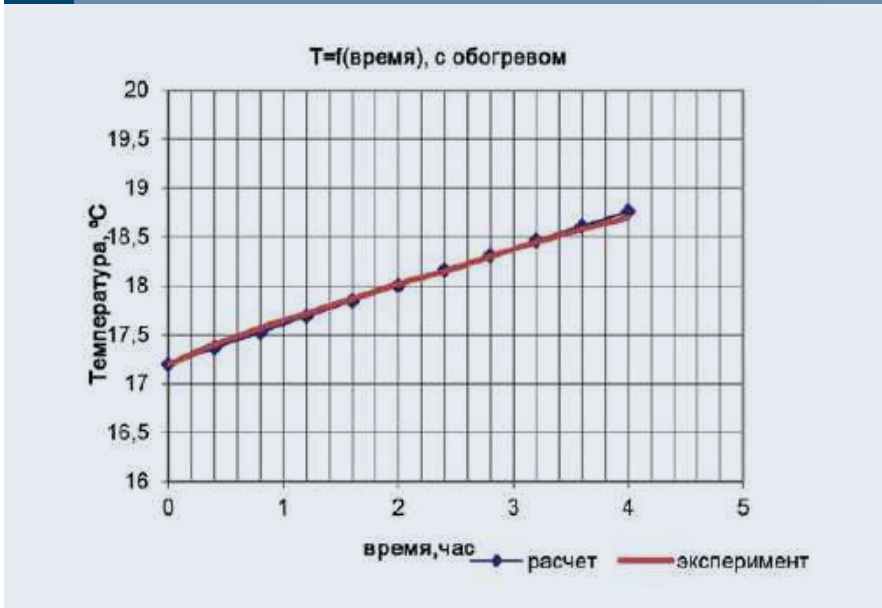
Рис. 7. Сопоставление расчетной и экспериментальной кривых разогрева при T_{воз} = -20^{\circ}\text{C} .
