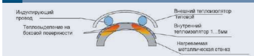
Рис. 1. Схема выделения тепла в металле объекта при индукционном обогреве
