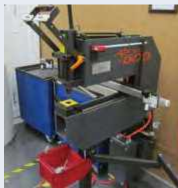
Рис. 10. Установка для пробивки отверстий Alfa
