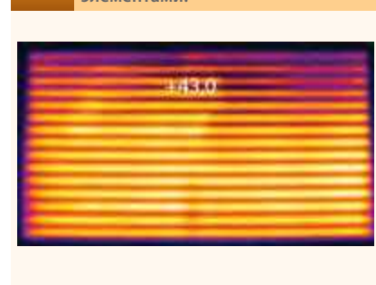
Рис. 10. Термограмма открытой нагревательной пленки с углеграфитовыми тепловыделяющими элементами.
