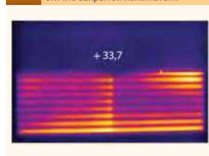
Рис. 11. Термограмма нагревательной пленки с углеграфитовыми тепловыделяющими элементами, частично закрытой ламинатом.
