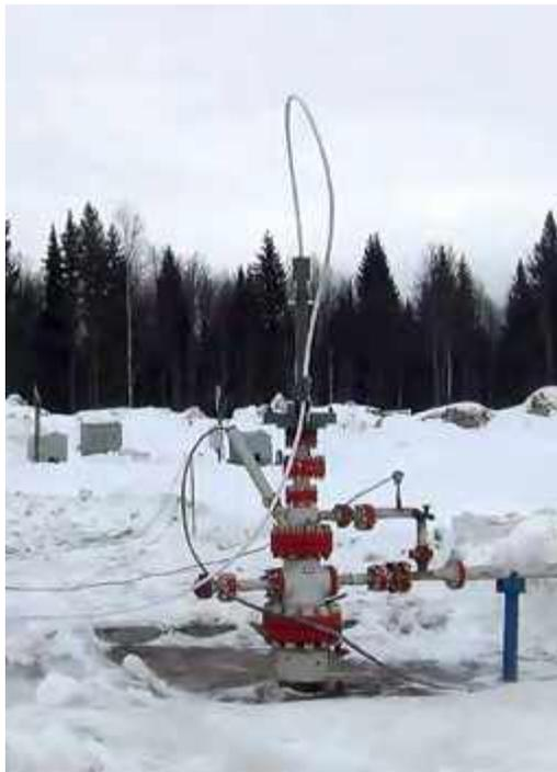
Рис.8. Выход нагревателя через лубрикаторный узел
