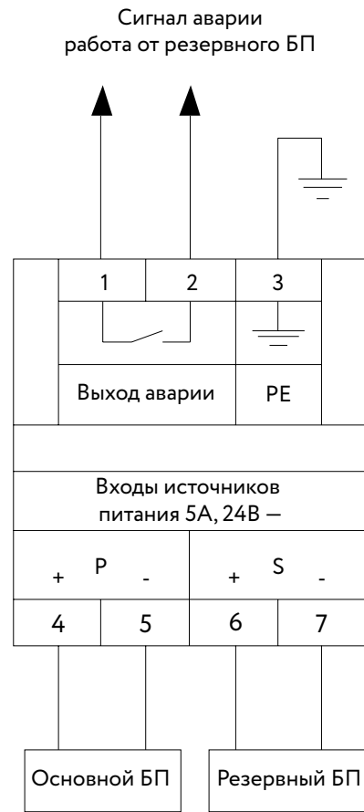
Рис. 13 Схема подключения модуля IPS к блокам питания
