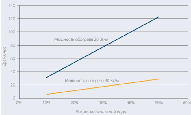
Рис.6. Процесс разогрева полностью замороженного трубопровода с глицерином диаметром 108 мм.
