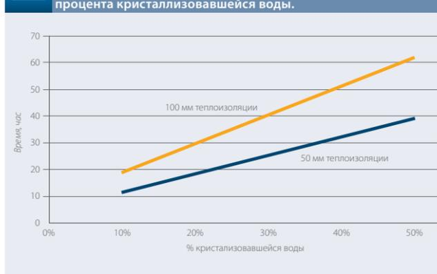
Рис.3. Процесс замораживания трубопровода с глицерином диаметром 108 мм и теплоизоляцией толщиной 50 мм.
